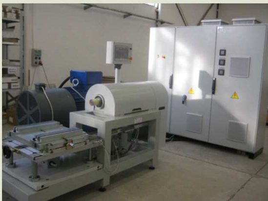
Тест стенд за изпитване на инвертори с мощност до 90kW
